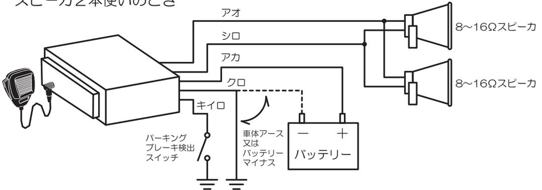
パーキングブレーキレバーを操作してパーキングブレーキ検出スイッチがオンする(閉じる)と、黄色線がアースされMP3音量を低下させる回路が起動します。黄色線をアースしている間はMP3音量が本体底部のミュート時音量ボリューム設定値になります。検出スイッチがオフする(開く)と低下状態が解除されます。
