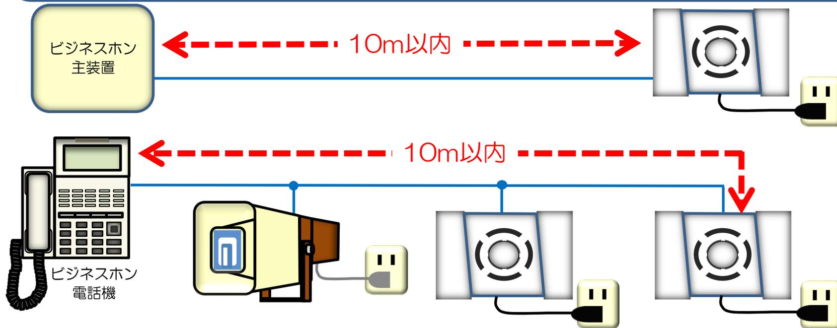
配線はできるだけ短くし、強いノイズを出すような器具、または電線から遠ざけてください
