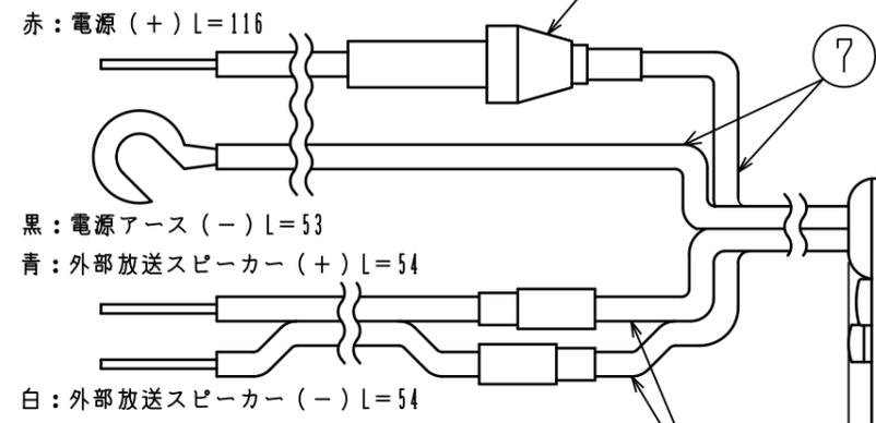
スピーカー線は定格インピーダンスが4~16Ωのスピーカーに接続してください。
