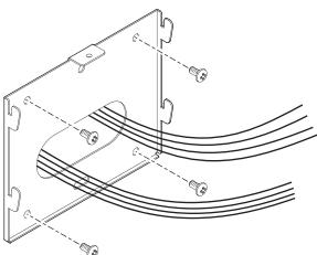
◎電線管用埋込ボックスをご使用の場合は、端子カバーを埋込ボックスに取り付けてください。
